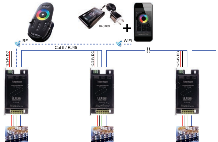
Anschlusschema 4 Kanal: Die Ansteuerung erfolgt in diesem Beispiel über die Wifi-Box, welche mit einer App bedient wird. Zusätzlich sind sind Controller mit einem Cat5 - Kabel synchronisiert, damit es bei langsamen Lichtwechseln keine verzögerung gibt.
